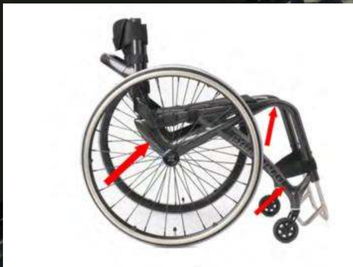
図 9: 持ち上げる箇所
